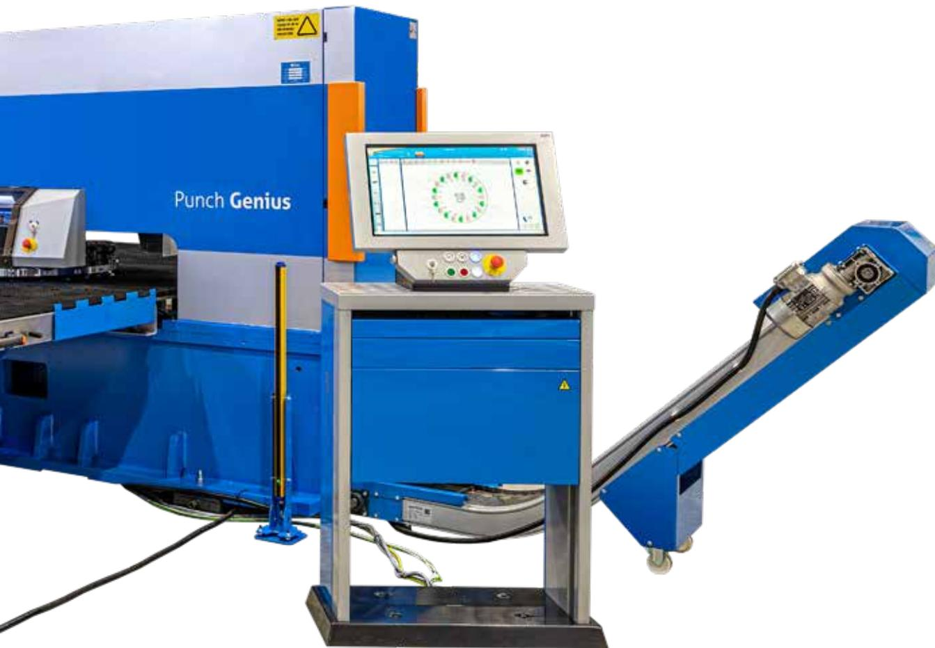
Controllo CNC Prima Power: controllo del movimento TwinCat basato su PC con motori ed azionamenti IndraDrive di Rexroth.
