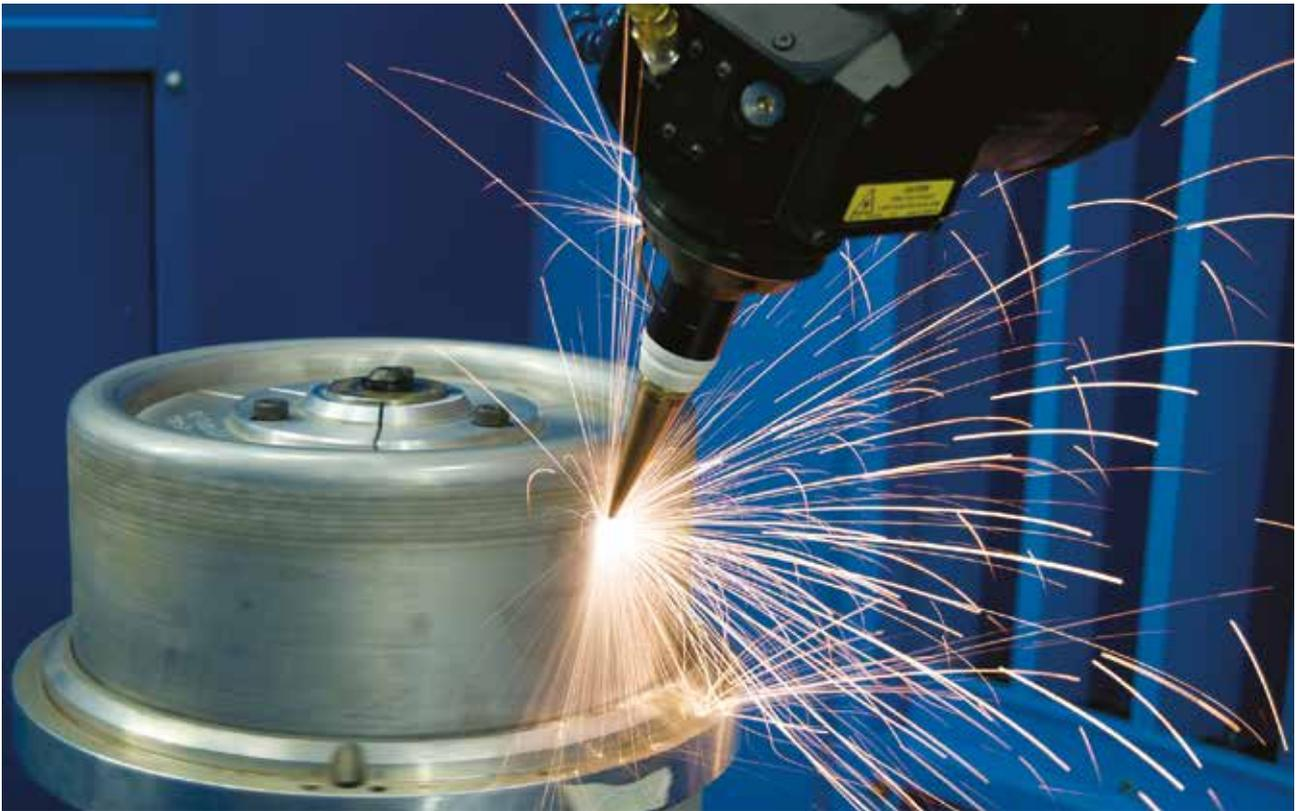
Le profil compact du LASERDYNE® BeamDirector® en fait la seule machine capable de forer à des angles aussi faibles que 10 degrés par rapport à la surface sur toute la course de l'axe Z.
