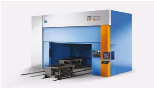
Configuration de tables mobiles avec mouvement manuel ou automatique, dans la direction X ou Y.
