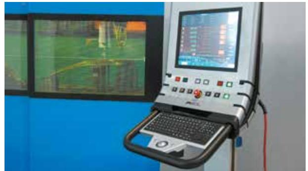
Commande numérique P30L de Prima Electro avec HMI puissante, grande puissance de calcul et CAM intégrée (en option).
