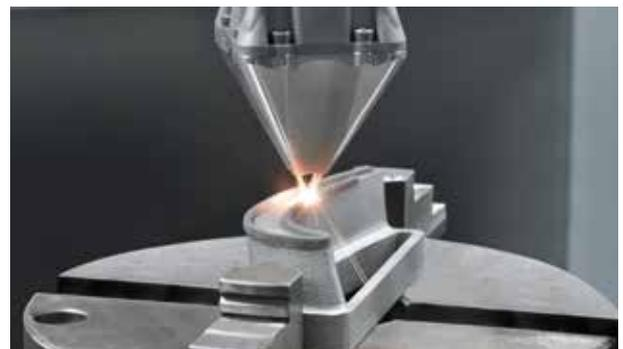
Bord d'aube de turbine en cours de construction à l'aide de la buse d'additif à 4 jets.
