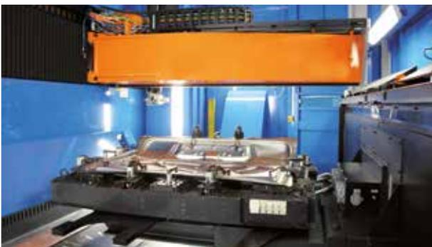
Moteurs linéaires sur les axes principaux et moteurs directs avec échelles optiques et sur la tête de mise au point : dynamique, précision et fiabilité supérieures.
