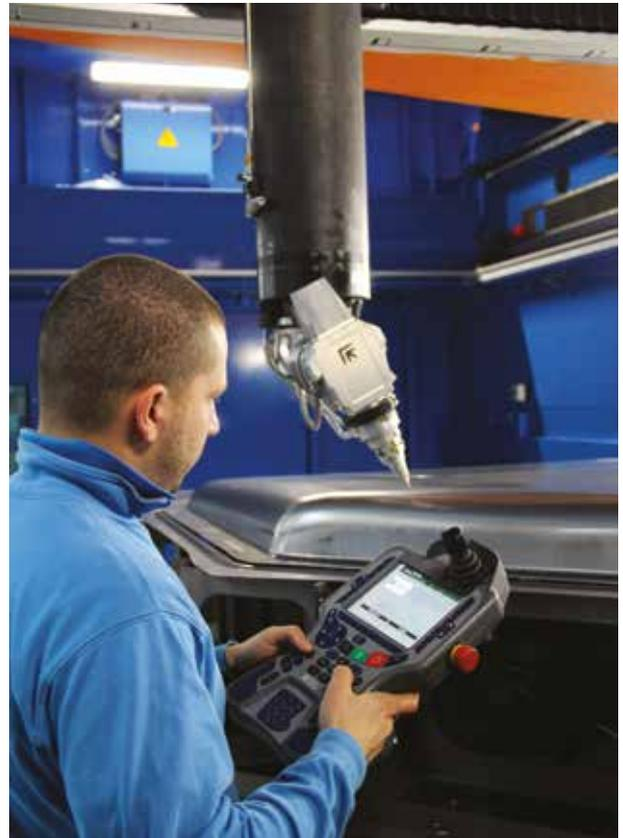
Axe Z et chariot principal en fibre de carbone en moulage d'aluminium.
