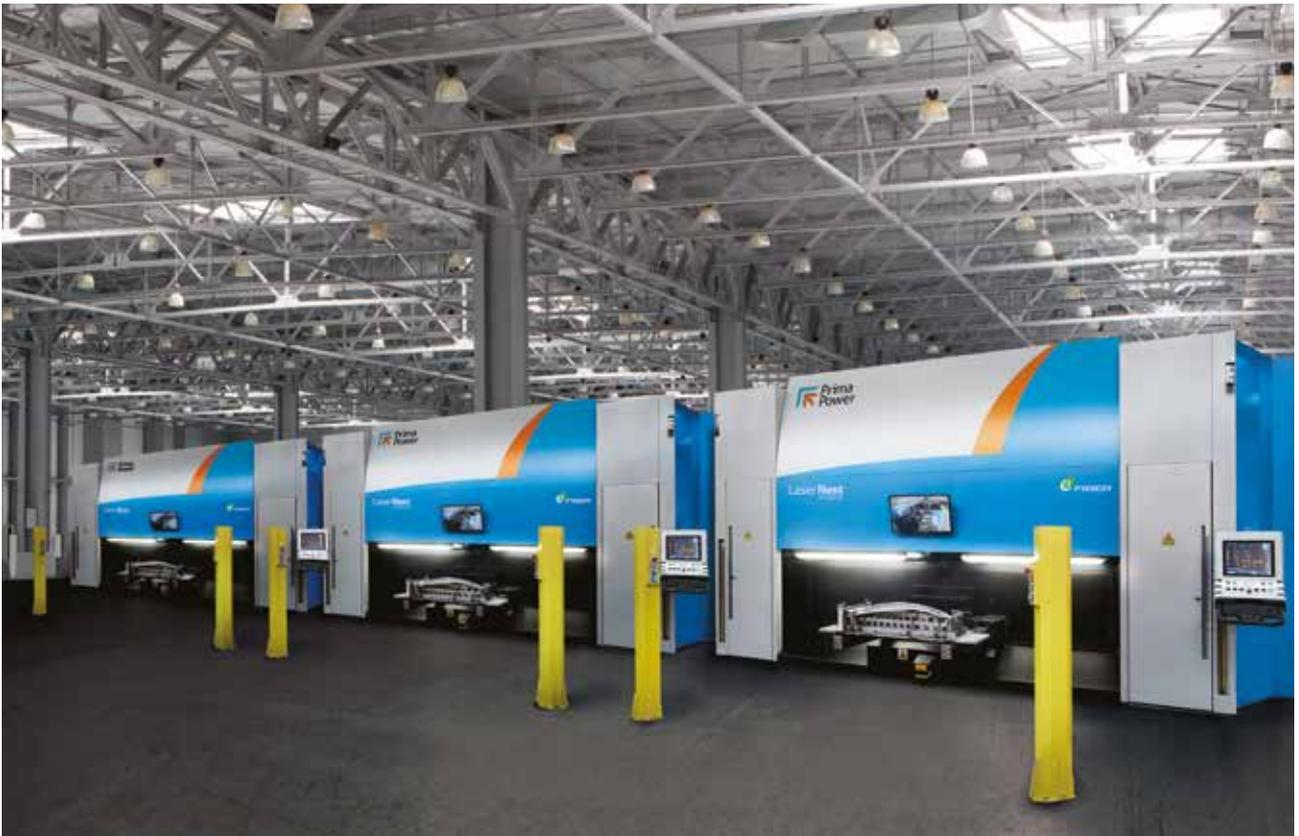
Configuration multi-machine pour le meilleur rapport encombrement-productivité : un seul convoyeur de déchets pouvant être utilisé jusqu'à trois machines. Disponible uniquement pour LN 1530 EVO.
