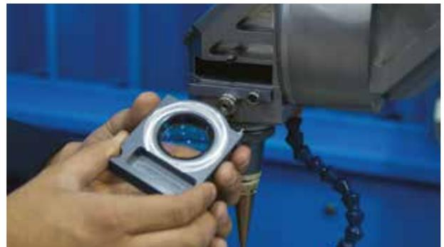
Le LASERDYNE® BeamDirector® permet de changer rapidement et facilement la lentille de mise au point et le couvercle de protection coulissant de la lentille.
