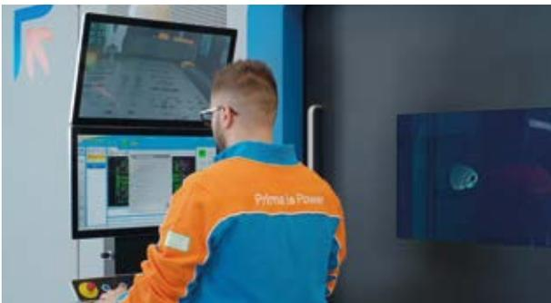
Ein standardmäßiger doppelter 24"-LCD-Touchscreen und eine integrierte 4K-Kamera dienen für die Echtzeitüberwachung des Arbeitsraumes.
