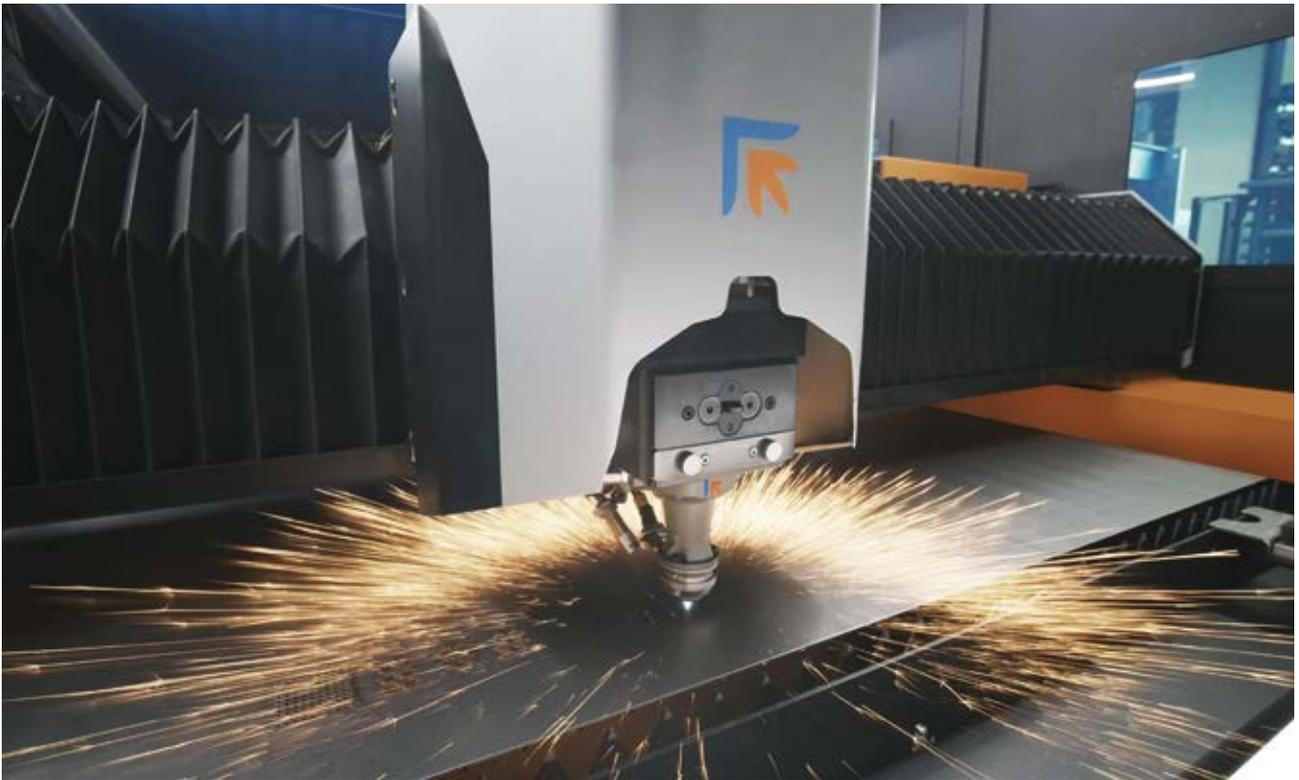
Erstklassige Dynamik, um niedrige Zykluszeiten bei hervorragender Schnittqualität zu gewährleisten. Die Laser Genius<sup>+</sup> kann eine breite Palette von Materialien mit einer Stärke von bis zu 30 mm mit hoher Qualität bearbeiten und kann mit Lasergeneratoren mit Leistungen von 2 bis 15 kW ausgestattet werden.
