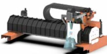
Automatische Erkennung von Kanten oder Profilen zur Unterstützung des Anwenders bei den Schneidvorbereitungen mit Hilfe eines Kamerasystems zur Erkennung der genauen Position des geladenen Blechs. Die Messsoftware ermöglicht es, dank einer hochauflösenden Kamera hochgenaue (+/- 0,15 mm) Referenzen auf dem Blech zu erstellen.
