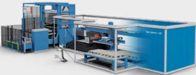
Geschnittene Teile werden nach dem Schneiden mit RALC (Robot Assisted Laser Cut) vom Tisch aufgenommen.
