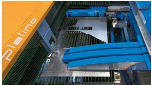
Platino ausgestattet mit LST zum Sortieren und Stapeln von Teilen.
