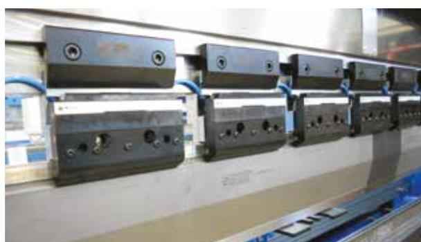
Fissaggio pneumatico tipo European con intermediari (H=100mm) con inserto utensili verticale.
