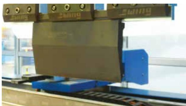
Fissaggio manuale tipo European Style con intermediari (H=100mm) in versione standard o rapida.
