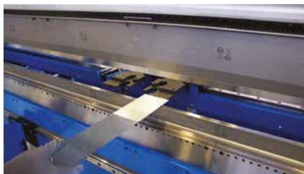
Fissaggio idraulico tipo Wila Style (standard o temprato - qui con opzione STL).
