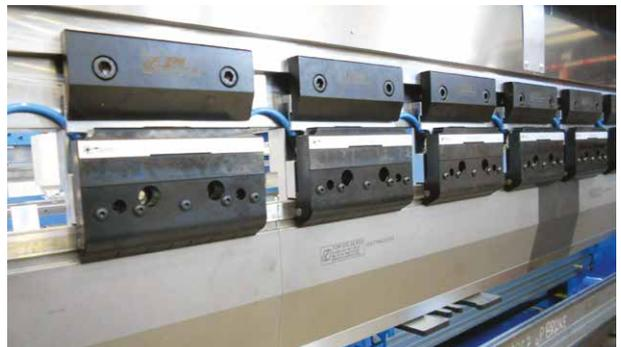
Sujeción neumática estilo Europeo con intermedios (H = 100mm) con inserción vertical de herramientas.
