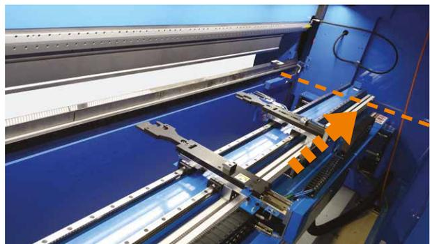
Posicionado sobre toda la longitud de plegado (en la foto, BG para eP-1336 y eP-2040).
