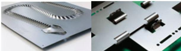
El cilindro servo-eléctrico e indexable up-forming de alta precisión proporciona una fuerza de 200 kN para el conformado rápido de formas incluso altas y complicadas y la deformación continua.
