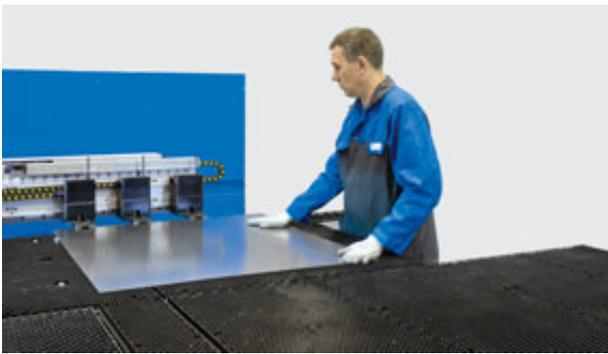
Las chapas se pueden cargar desde ambos lados de la máquina. Las mesas móviles facilitan la carga sin necesidad de esfuerzo y las bolas de elevación soportan la chapa mientras las mordazas se cierran.
