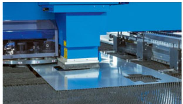
Las piezas cortadas por láser de hasta 500 x 500 mm se dejan caer a través de la trampilla situada en la mesa sobre el transportador de debajo.
